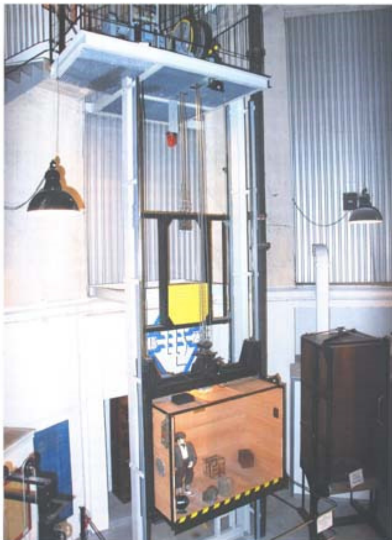
Steuerung für Personenaufzug (Zweiergruppe) aus dem Jahre 1963.
